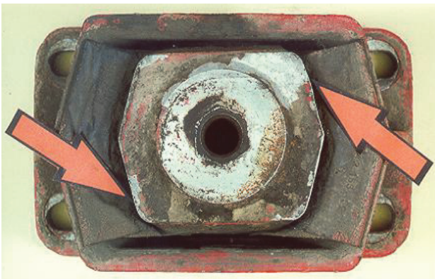
Abb. 2: Verschleiß von Gummimetallteilen
