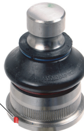
Fig. 2: Articulație de suspensie cu canelură (balansier transversal jos)
