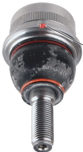
Fig. 1: Articulație de suspensie cu canelură (balansier transversal sus)
