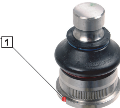
Fig. 2: Suspensão articulada com entalhe (braço de controle em baixo)
