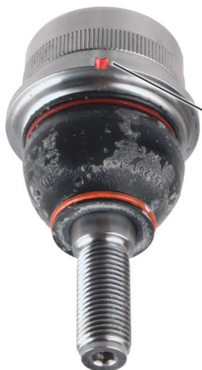
Fig. 1 : Suspension articulée avec entaille (bras oscillant transversal en haut)
