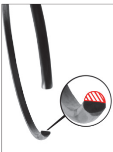
Fig. 3: Anillo de retención desgastado.
