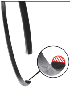
Εικ. 3: Φθαρμένος δακτύλιος ασφαλείας.
