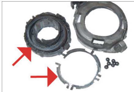
Εικ. 4: Μηχανικές ζημιές και υπερθέρμανση του εξαρτήματος αποσύμπλεξης
