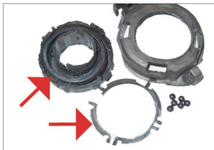
Рис. 4: Механические повреждения и перегрев выжимного подшипника
