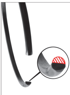
Рис. 3: Износ стопорного кольца.
