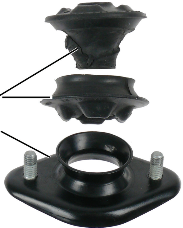
Рис. 2. Повреждённая верхняя опора амортизационной стойки
