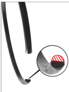
Obr. 3: Opatrený poistný krúžok. → vypínacie ložisko sa uvoľňuje z membránovej pružiny → nárazový silový záber
