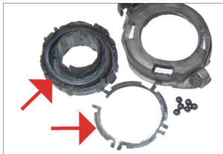
Obr. 4: Mechanické poškodenia a prehriatie vypínacieho ložiska
