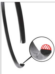
Fig. 3: Anel de segurança desgastado
