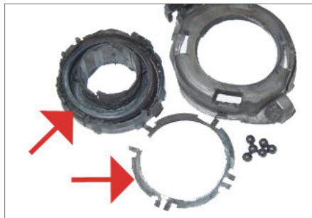
Figura 4: danni meccanici e surriscaldamento del perno di disinnesto
