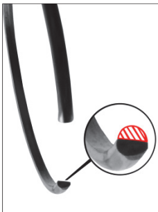
Figura 3: anello di sicurezza usurato. → Il perno di disinnesto si sgancia dalla molla a diaframma → Accoppiamento dinamico brusco
