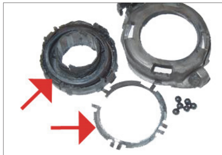
Kuva 4: Mekaanisia vaurioita ja ylikuumenemista irrotinlaakerissa
