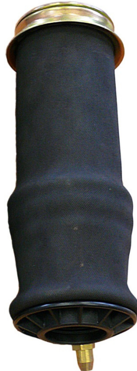
Slika 2: Aktuelna pneumatska elastična opruga za vešanje 27-F97-0
