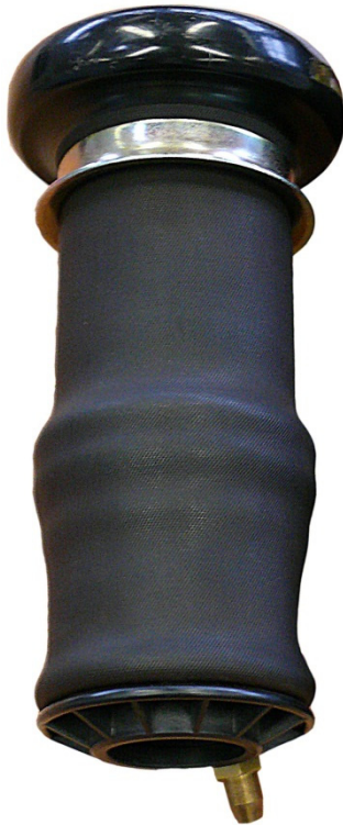
Slika 1: Zamenjena pneumatska elastična opruga za vešanje 27-C33-0
