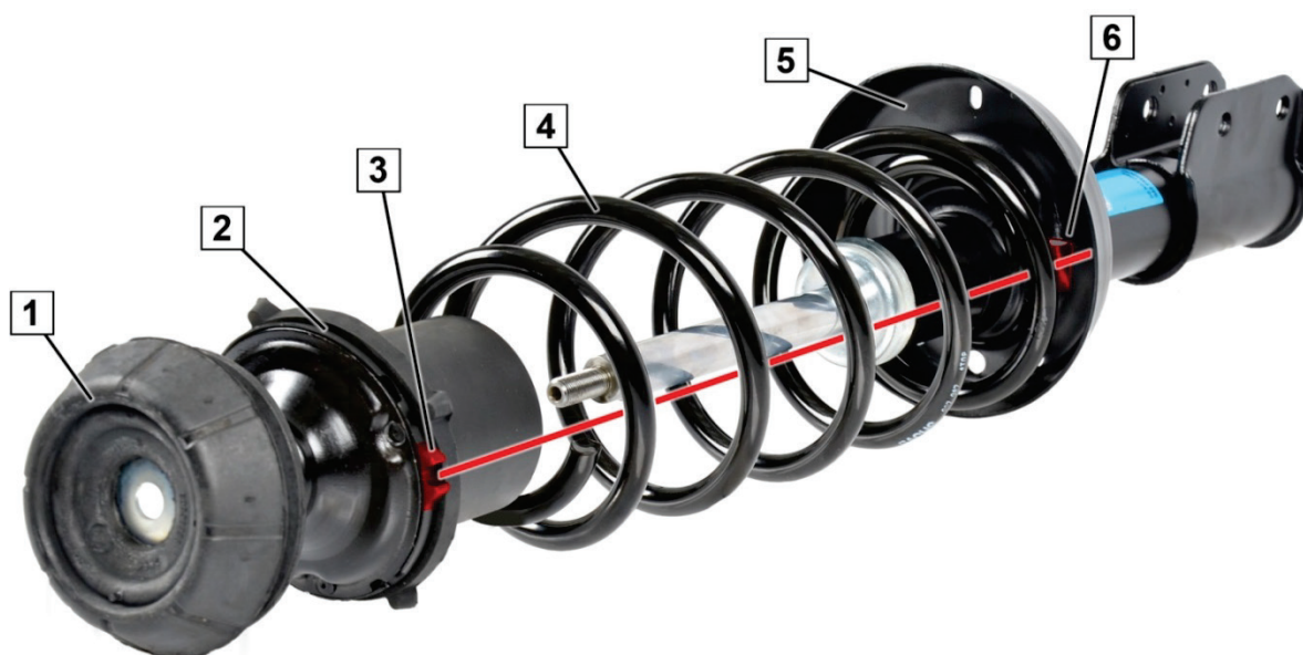
Obr. 1: Správně nastavená poloha opěrného ložiska pružící jednotky
