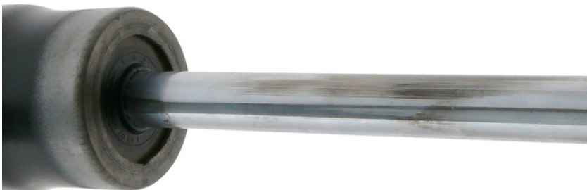
Obr. 2: Vlivem napružené montáže jednostranně opotřebovaná vrstva chromu pístnice
