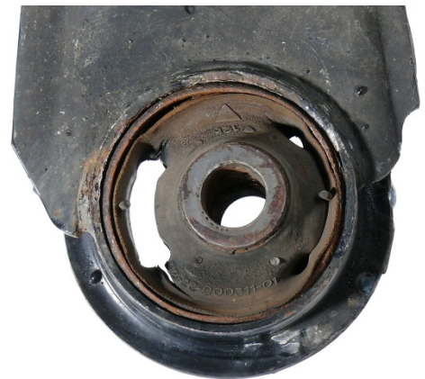
Obr. 3: Vadné pryžokovové ložisko
