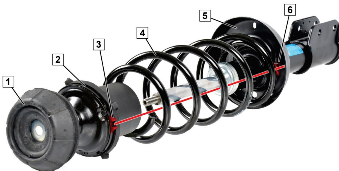
Obr. 1: Správne polohované tlmiace ložisko
