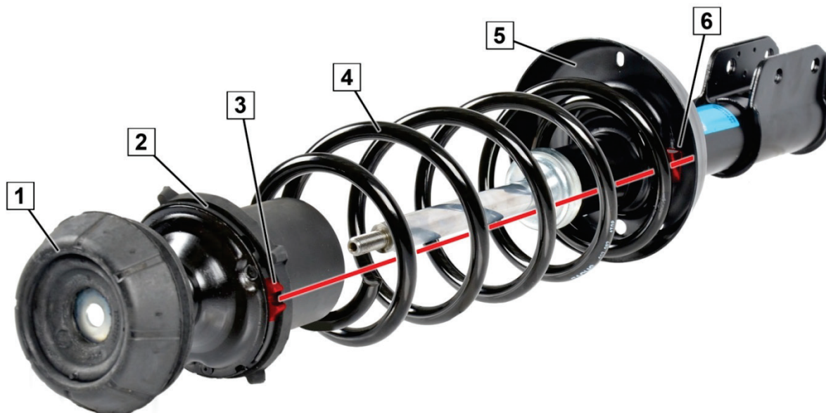
Fig. 1: Poziționarea corectă a rulmentului de sarcină
