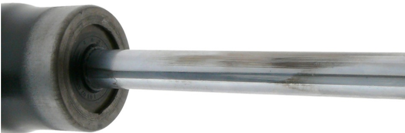
Fig. 2: Cromado do pistão desgastado de um lado devido à montagem torta
