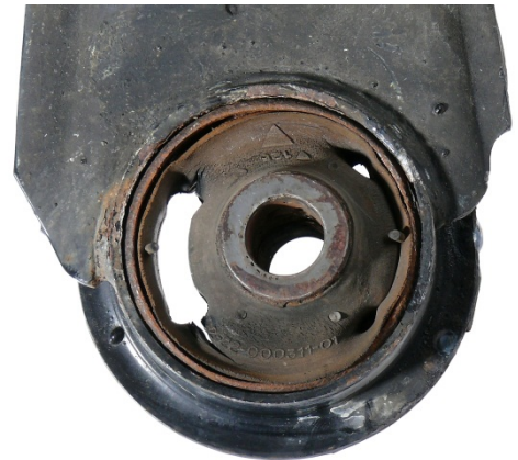
Sl. 3: Gumeno-metalni ležaj neispravan
