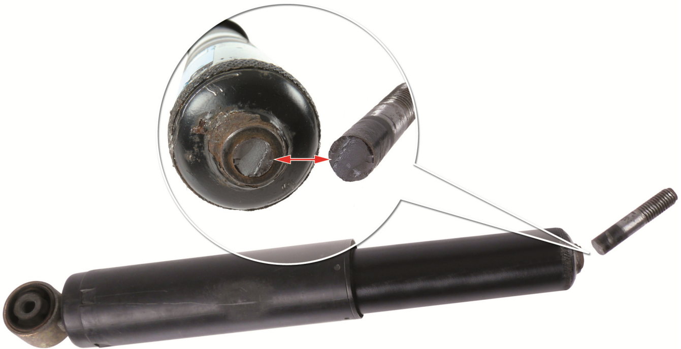
Abb. 1: Stiftgelenk durch wechselnde Biegebelastung gebrochen
