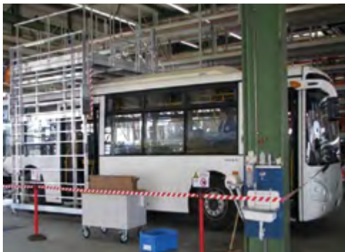
Bild 8: Beispiel für Absichern des Arbeitsbereichs bei Prüfarbeiten
