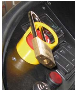
Bild2: Beispiele für das Sichern gegen Wiedereinschalten
