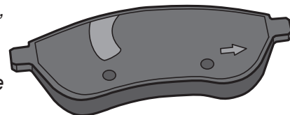
Pastilha de travão com informação sobre a posição de montagem e entalhe na face traseira.
