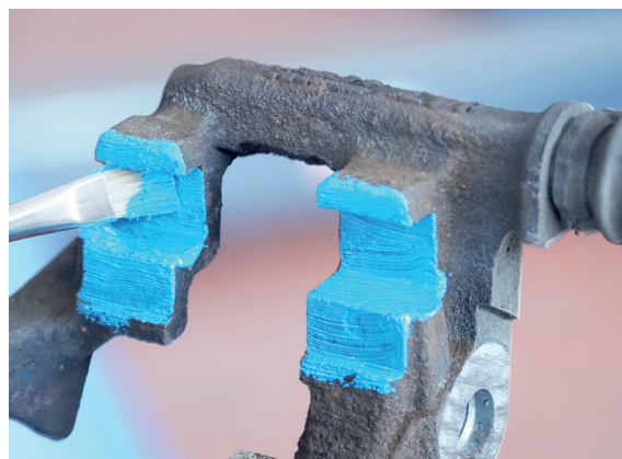
Guía de pastillas tratada con NOxidation
