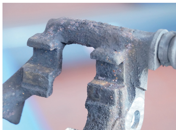
Guía de pastillas corroída
