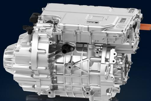
Il ZF Electric Axle Drive è dotato di un sistema di azionamento elettronico integrato con motore elettrico, elettronica di potenza e riduttore per un design compatto. Ora, ZF Aftermarket sta introducendo una gamma di 43 kit di riparazione.
