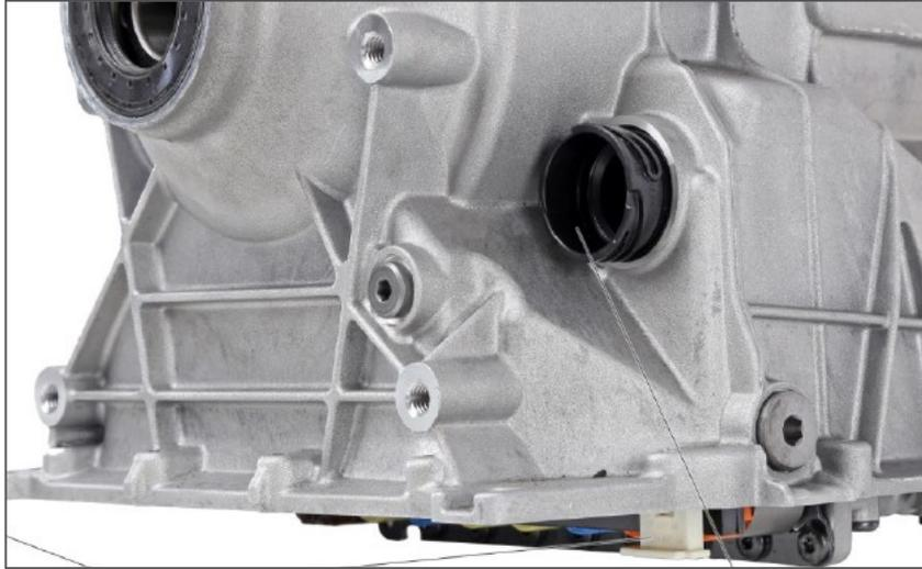
Crea una tenuta tra il connettore del sistema meccatronico e l'alloggiamento della trasmissione
