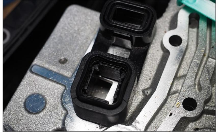
Crea una tenuta tra il sistema meccatronico e la trasmissione, l'alimentazione della pressione del sistema da / verso la pompa dell'olio
