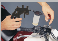
1. Aspirare il liquido dei freni dalla vaschetta serbatoio.
