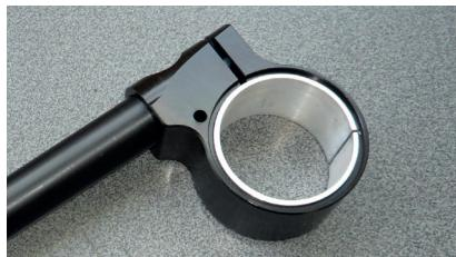
1. Para facilitar el montaje, aplique una grasa adecuada sobre la parte cónica de la barra del manillar (extremo con orificio roscado para la abrazadera de sujeción).
