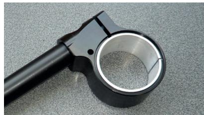
1. Per un montaggio più semplice applicare un grasso adatto sulla parte conica del semimanubrio (estremità con foro filettato per la fascetta di fissaggio).
