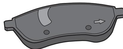
Rückenplatte mit Aussparung (Kolbenseite) und Angabe der Einbaurichtung
