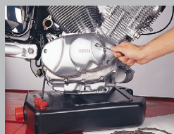
1. Werkzeug bereitlegen, Boden abdecken, Öl ablassen, Deckel freilegen.
