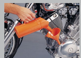
9. Öl einfüllen, Maschine fahrbereit machen, Probelauf.
