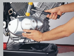
2. Schrauben schrittweise lösen, Deckel entfernen, Dichtflächen reinigen, auf Passhülsen achten.
