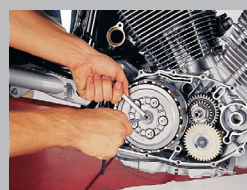
6. Kupplungsspiel am Ausrückmechanismus einstellen, je nach Fahrzeug unterschiedlich.
