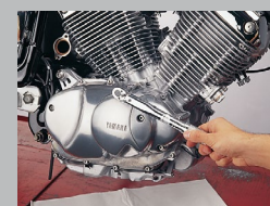
7. Deckel mit einwandfreier Dichtung aufsetzen; Passhülsen beachten; Schrauben schrittweise anziehen.
