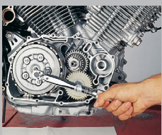
5. Montage mit Reibbelag beginnen, Schrauben an Druckplatte schrittweise anziehen.
