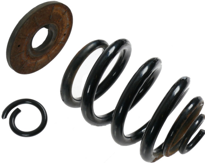
Abb.1: Verschlissener Federteller und gebrochene Fahrwerkfeder
